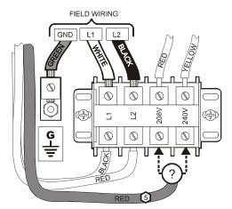
Fig. 4 Terminal Block Wiring
